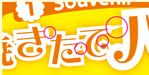
事例4：印刷工程でフチ文字にツノが発生
