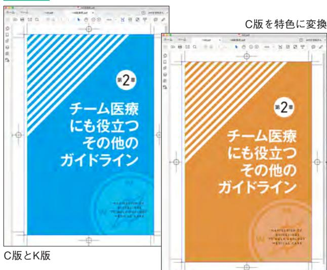
2色印刷のデータは、一般的にプロセスカラー（C版とK版もしくはM版とK版）で作成します。実際の刷色が特色の場合、刷色と異なる色で校正しなければなりません。しかしPitStopを使って特色に変換することで実際の刷色に近いイメージを再現できます。
